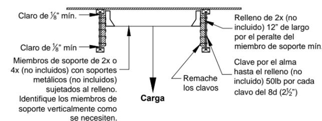
NOTA: utilice este detalle para cargas de más de 250lbs. Por vigueta I. Una carga de 250lbs. Puede ser soportada en cada lado del patín inferior de la vigueta a 5'-0" de centro a centro, esto si la carga está incluida en las cargas de diseño normales.
