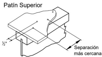
**Conexión de vigueta:** Para patines de 1-3/8" de espesor, sujétela con un clavo del 8d(2-1/2") box, mínimo a cada lado en el apoyo de la vigueta Red-I™. Use clavos del 10d (3") box en patines de 1-1/2" de espesor, 12d (3-1/4") box en patines de 1-3/4" de espesor y clavos del 16d (3-1/2") box en patines de 2-1/2" de espesor. Mantenga 1-1/2" de distancia mínima de la punta de la vigueta para minimizar rajaduras.
