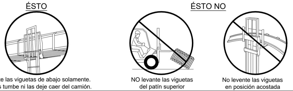
Levante las viguetas de abajo solamente. NO las tumbes ni las deje caer del camión.
